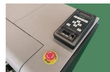
Pulsante di arresto d'emergenza + pannello di controllo stampante UV
